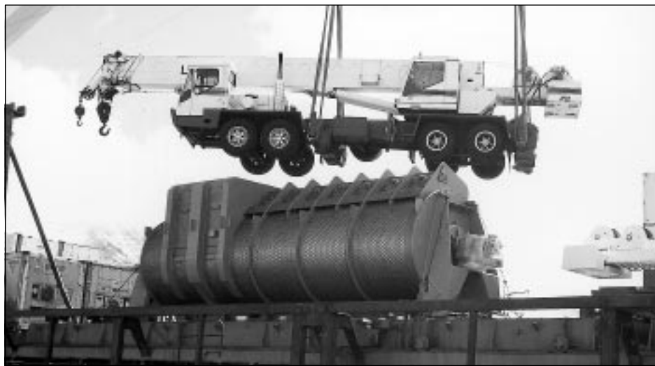
Nýi þurrkarinn vegur 80 tonn og þurfti m.a. að flytja tvo 50 tonna kranabíla til Bolungarvíkur til að skipa ferlíkinu á land og koma því fyrir í Gná.
