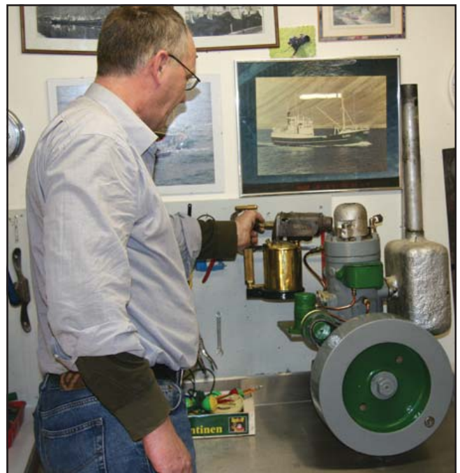
Einar Þarf að hita vélina með gaslampa í klukkutíma áður en hún er keyrð.
